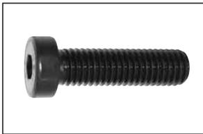
一般的な六角穴付きボルトに比べて頭部が低いことにより締結時に他の部品との干渉が減り、狭い場所での使用に適します。締付け後の出っ張りが目立たず美観良く、相手材へ埋込む際は通常のキャップスクリューよりも浅いザグリですみます。また、軽量、コンパクトで設計の自由度が広がります。
