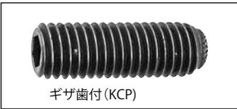
▶ 止めねじの保持力は据付けトルクと比例し、より強く締付ければ、より高い圧縮力が得られます。アンブラコの止めねじは、他の止めねじよりも20%以上、最大で40%の高い締付けトルクを推奨しています。寸法の均一性と剪断力が高まる谷底RのUNRねじ、また深く正確な六角穴を持ち、これらにより高い締付けトルクを可能とし、より高い圧縮力が得られます。くわえて先端のギザ歯(KCP)が強固なゆるみ止め機能と耐振保持力を発揮します。
